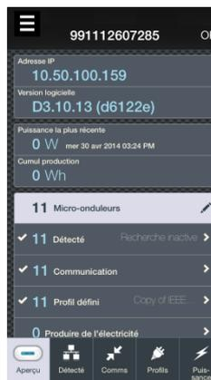
La partie supérieure de l'écran d'aperçu affiche les informations système actuelles, notamment l'adresse IP, la version du logiciel, la production d'électricité la plus récente et l'énergie sur toute la durée d'exploitation. À droite de l'adresse IP, l'écran affiche le statut Wi-Fi si un adaptateur sans fil
