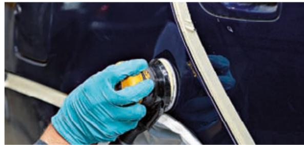
**2a Lijado.** Alise/Nivele la superficie a mano. Use el disco de lijado de Mirka P 1500 de 77 mm. Alternativas: Abranet Soft en húmedo o Q.Silver®/Polarstar en húmedo o seco. Reduzca además el patrón de rayado con lijado húmedo a máquina. Use Abranet Soft 2500 o Abralon® 2000/4000.
