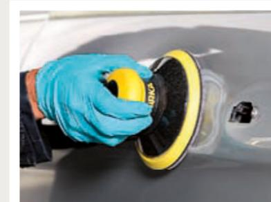
Retire la pintura de la parte dañada y bisele los bordes. Use el disco con sujeción P 80 de Mirka.
