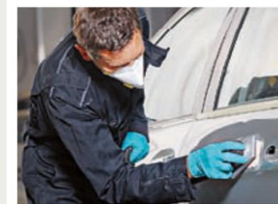
Lije la zona con lijado manual usando la tira Abranet® P 80 de Mirka.
