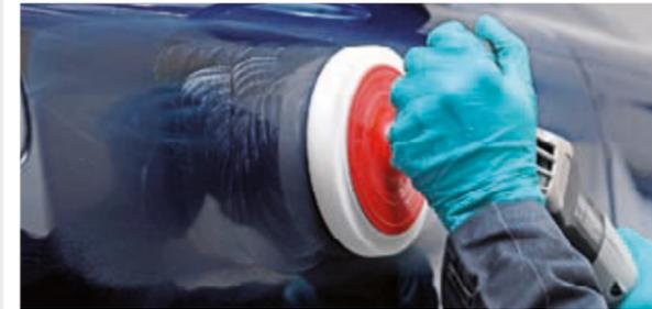
**3b Composición.** Retire las marcas de lijado con Polarshine C20 y el plato de espuma blanco de 150 mm.
