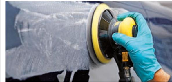
**3a Lijado.** Alise/Nivele la superficie a máquina. Use el disco de lijado de Mirka P 1500 de 150 mm. Alternativas: Abranet Soft en húmedo o Polarstar en húmedo o seco + separador acolchado. Reduzca además el patrón de rayado con lijado húmedo a máquina. Use Abralon 2000/4000.
