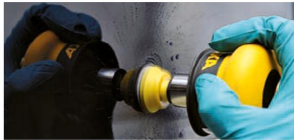
**1a Lijado.** Retire las puntas sucias a máquina o a mano. Use el disco de Mirka de 34 mm P 2500. Alternativas: Abranet Soft o WPF.
