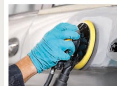
Para reducir el patrón de rayado lije con el disco con sujeción de Mirka P 500. Alternativas: Autonet™, Gold o Q. Silver®.
