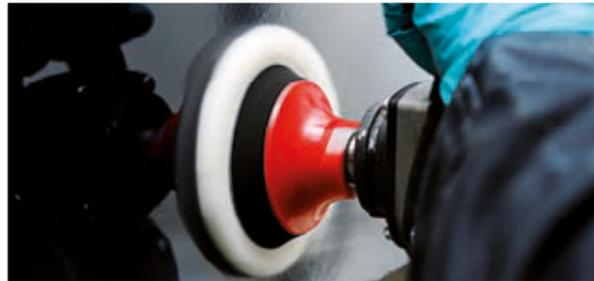
**1b Composición.** Retire el rayado de lijado con Polarshine T10 y el plato de lana de 77 mm.
