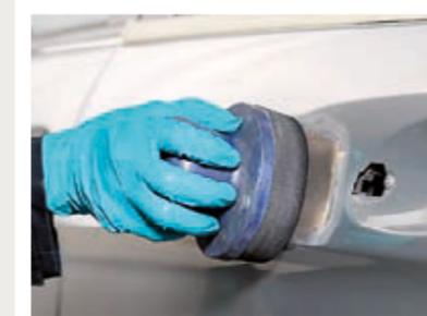
Aplique la capa guía de Mirka para destacar las imperfecciones de la superficie.
