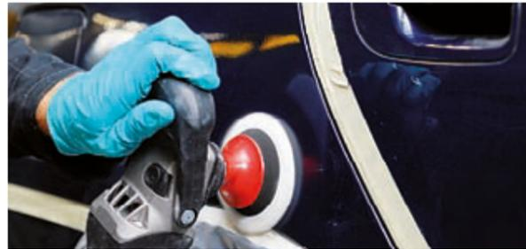
**2b Composición.** Retire las marcas de lijado con Polarshine T10 y el plato de lana de 77 mm o 150 mm.
