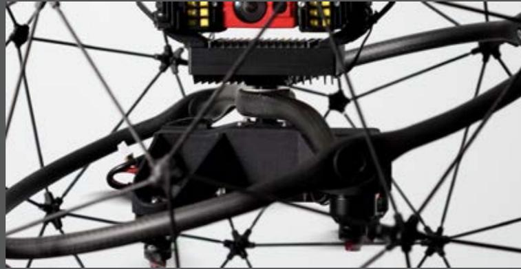
A estrutura protetora do Elios não é qualquer uma. Ela desacopla sobre três eixos a partir da estrutura interna - o drone - usando um mecanismo de suspensão gardan. Este engenhoso mecanismo de desacoplamento é o que permite ao Elios permanecer estável em caso de colisão.
