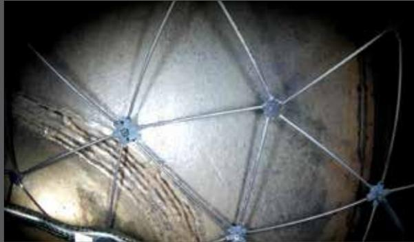
Lors d'un vol en contact avec une surface, Elios peut prendre des images avec une résolution submillimétrique de 0.2 mm/px.
