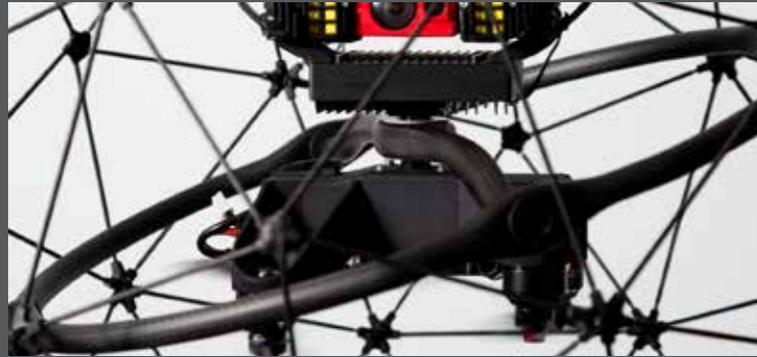
La cage protectrice d'Elios n'a rien d'ordinaire. Elle est découplée sur trois axes de la partie interne - le drone - en utilisant un système de cardan. C'est ce découplage ingénieux qui permet à Elios de conserver sa stabilité lors de collisions.
