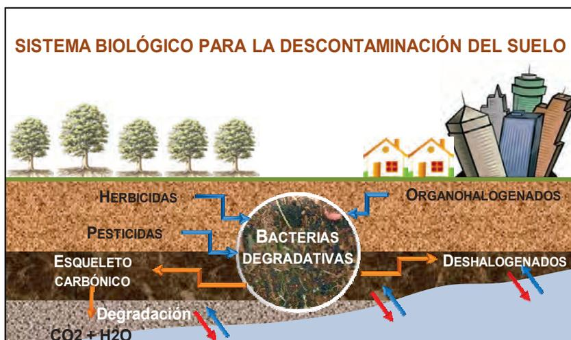
**Figura 6.15** Como actúan las bacterias del suelo sobre los diferentes contaminantes que se encuentran en el suelo (Fuente: modificado de <http://www.naturalbiotec.com/pdf/Biorreactor.pdf>).
