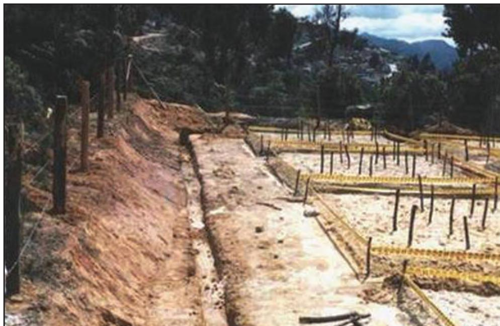
**Figura 5.15** Encerramiento del área experimental y zanja perimetral colectora de las aguas lluvias de las áreas adyacentes.
