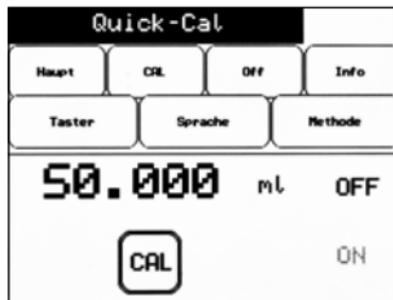
Nach erfolgreicher Aktivierung des Kundenkalibrierwertes durch drücken der Taste „CAL“ wechselt die rechte Anzeige auf „ON“ und auch im Hauptfenster erscheint neben dem Volumen der Hinweis „CAL“. Das Gerät korrigiert nun automatisch jedes zu dosierende Volumen anhand der vorgenommenen Kalibrierung.
