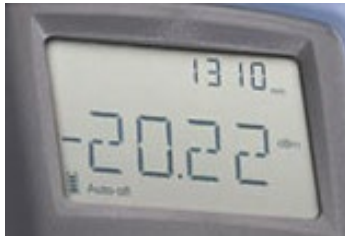
Ein Power Meter misst die Gesamtleistung
