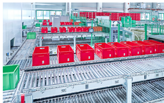
3 | Andienung der Quell- und Auftragsbehälter an der Kommissionierarbeitsplätze.
