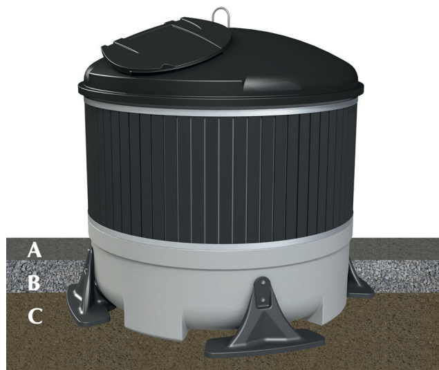
A - Viimeistelykerros, 100 mm B - Ankkurointikerros, sepeli 0/32, 400 mm C - Tasauskerros, murske 0/16, väh. 50 mm
