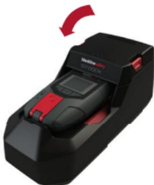
3. Refermez le couvercle de la station G7 en le poussant jusqu'à ce que les languettes d'ouverture soient bien enclenchées des deux côtés.
