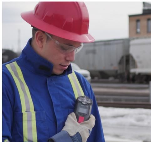
I dispositivi G7 con cartuccia a gas singolo o multigas sono in grado di rilevare i gas nocivi presenti nell'ambiente.
