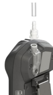
Per eseguire un campionamento con la pompa, collegare un innesto rapido a un tubo lungo quanto necessario. Fissare l'innesto rapido all'ingresso allineando le guide e ruotando in senso orario.
