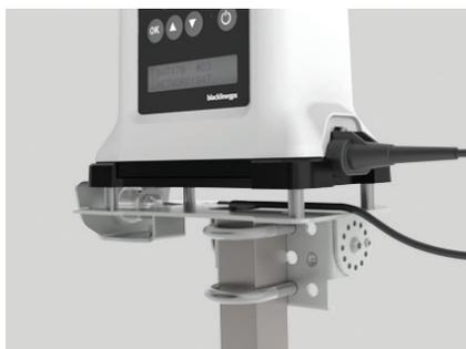
Aparafuse o suporte multipropósito na placa do suporte de montagem do G7 Bridge. Prenda o Suporte de montagem do G7 Bridge ao teto, cama ou poste usando o suporte em U de tamanho apropriado. Deslize e prenda o G7 Bridge no suporte multipropósito, e prenda o suporte de montagem do G7 Bridge com uma chave para segurança adicional.
