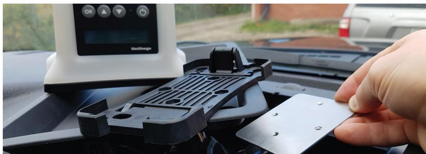
Remova o painel ou a porção do painel na qual deseja montar. Aparafuse o suporte multipropósito no topo do painel, depois aparafuse a placa do painel sob a bandeja para prender o suporte no local. Essa opção é ideal para veículos Ford F-150 com bandejas removíveis, para evitar fazer furos diretamente no painel do veículo.
