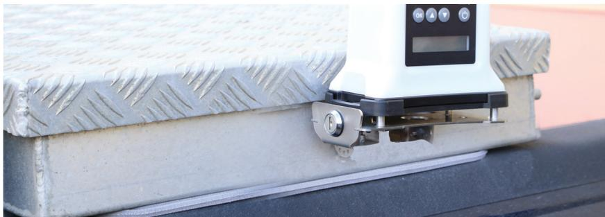
O G7 Bridge pode ser montado em uma caixa de transporte se houver uma linha de visão desobstruída para o céu. Aparafuse o suporte multipropósito à placa do suporte de montagem do G7 Bridge e aparafuse a placa ao lado da caixa de transporte. Deslize e prenda o G7 Bridge no suporte multipropósito, depois prenda o suporte de montagem do G7 Bridge com uma chave para segurança adicional. Certifique-se de que a tela LCD está virada para o lado externo.
