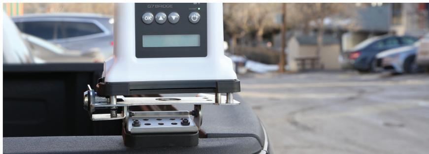
Aparafuse o ponto de ancoragem no trilho, depois prenda o suporte de montagem do G7 Bridge no ponto de ancoragem usando parafusos. Aparafuse o suporte multipropósito na placa do suporte de montagem do G7 Bridge. Deslize e prenda o G7 Bridge no suporte multipropósito, depois prenda o suporte de montagem do G7 Bridge com uma chave para segurança adicional.
