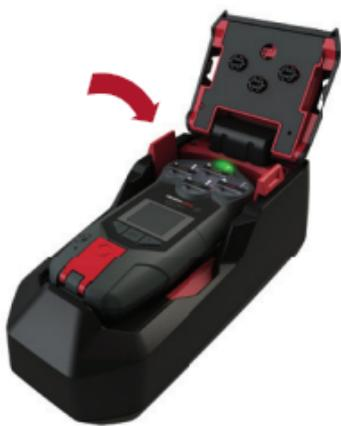
2. Mantendo os cliques de carregamento conectados, coloque o G7 de forma plana e empurre até que encaixe firmemente no lugar.
