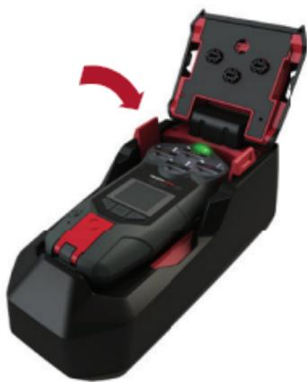
2. Con los enganches de carga conectados, apoye horizontalmente el dispositivo G7 en la estación y presiónelo hasta que encaje en su sitio.
