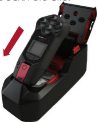
1. Deslice el dispositivo G7 en el enganche de carga de la estación de manera que los enganches de carga de ambos dispositivos encajen.
