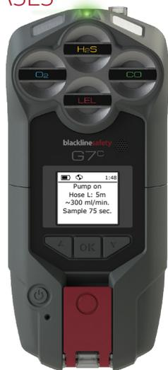
Quando um cartucho de bomba é instalado no G7, é possível ver a tela de status da bomba ao pressionar as setas para cima ou para baixo na tela principal do G7. Aqui você pode ver se a bomba está ligada ou desligada, o comprimento da mangueira, a taxa de fluxo e o tempo de amostragem (se ativado).
