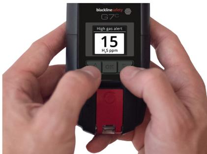
Evacue a área e siga o protocolo de segurança em emergências. Leia as informações na tela do G7. Pressione simultaneamente e mantenha pressionados os botões de seta para cima e para baixo para silenciar o som e a vibração. O som e a vibração voltarão depois de um minuto. Isso continuará até que os níveis de gás ou as médias diminuam ou voltem para concentrações aceitáveis.
