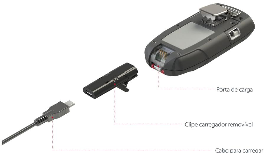
**OBSERVAÇÃO:** Caso possua o acessório G7 PowerPack conectado ao dispositivo, basta deslizar o clipe de carregamento para a porta de carregamento do PowerPack. Tanto o PowerPack quanto o G7 serão carregados simultaneamente.
