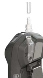
Para coletar amostras com a bomba, conecte um conector de engate rápido ao comprimento desejado da tubulação. Conecte um conector de engate rápido à chaminé alinhando as guias e girando no sentido horário.
