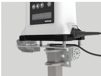
Atornille el soporte multipropósito a la placa del soporte de montaje del G7 Bridge. Fije el soporte de montaje del G7 Bridge a una baca, a la caja del vehículo o a un poste utilizando el tamaño de soporte en U adecuado. Deslice y enganche el G7 Bridge en el soporte multipropósito y bloquee el soporte de montaje con la llave para una mayor seguridad.
