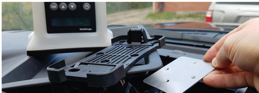
Retire la bandeja o la parte del salpicadero donde desea montarlo. Atornille el soporte multipropósito a la parte superior del salpicadero, luego atornille la placa debajo de la bandeja para asegurar el soporte en su lugar. Es ideal para instalar en un Ford F-150 con bandeja extraíble para evitar tener que perforar el salpicadero del vehículo.
