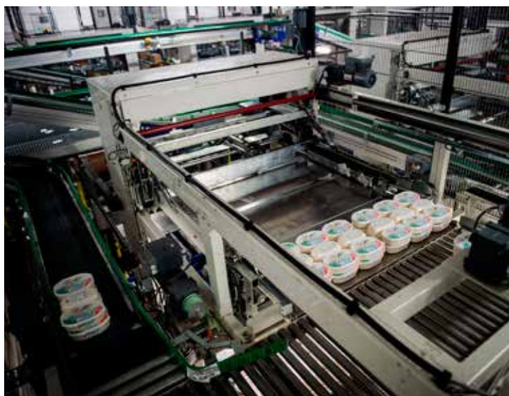
Pakkingen av iskrem hos Hennig-Olsen Is er en av produksjonsprosessene som er fullautomatisert. Selskapet har likevel ønske om å automatisere og ta i bruk ny teknologi i flere prosesser. FOTO: JACOB BUCHARD
