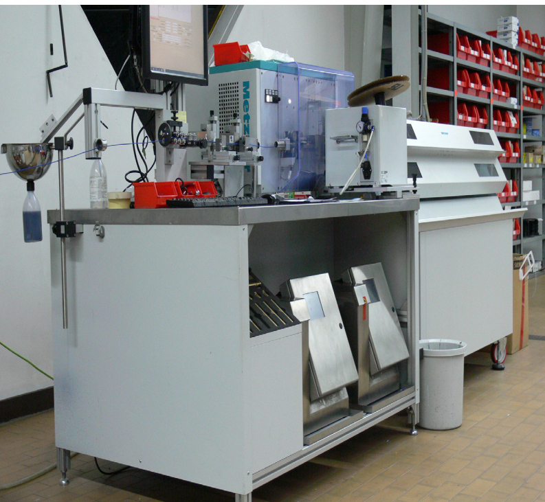
Bild 2: Ingela hat schon frühzeitig in eine automatisierte Drahtbedruckung und -konfektionierung investiert
