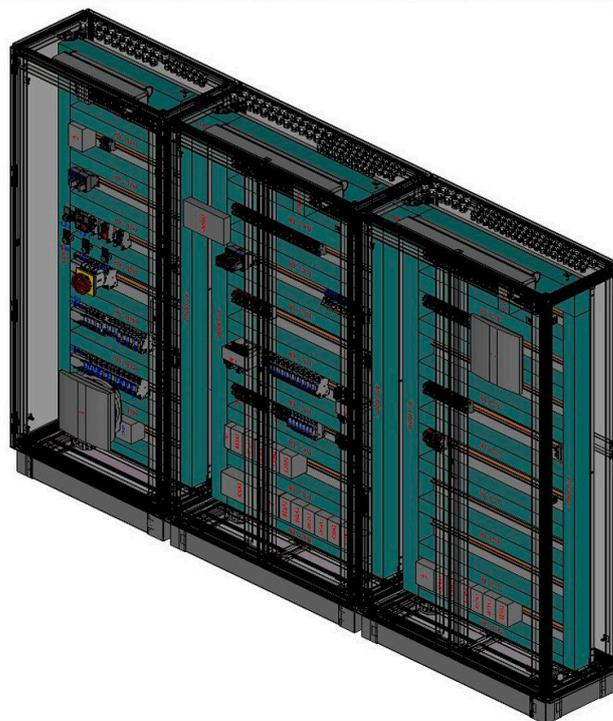
Darstellung von EPLAN Pro Panel als Datenbasis. Wenn der Draht verlegt ist, quittiert der Mitarbeiter die Aufgabe, und ihm wird der nächste zu verlegende Draht angezeigt. Aktuell ist nur einer der Verdrahtungs-Arbeitsplätze mit EPLAN Smart Wiring ausgestattet. Christian Eberl: „An den anderen Arbeitsplätzen arbeiten wir noch manuell und papiergestützt. In Kürze werden wir aber zu 100% das Smart Wiring-System nutzen – und in einem weiteren Schritt einen Verdrahtungsroboter anschaffen.“
