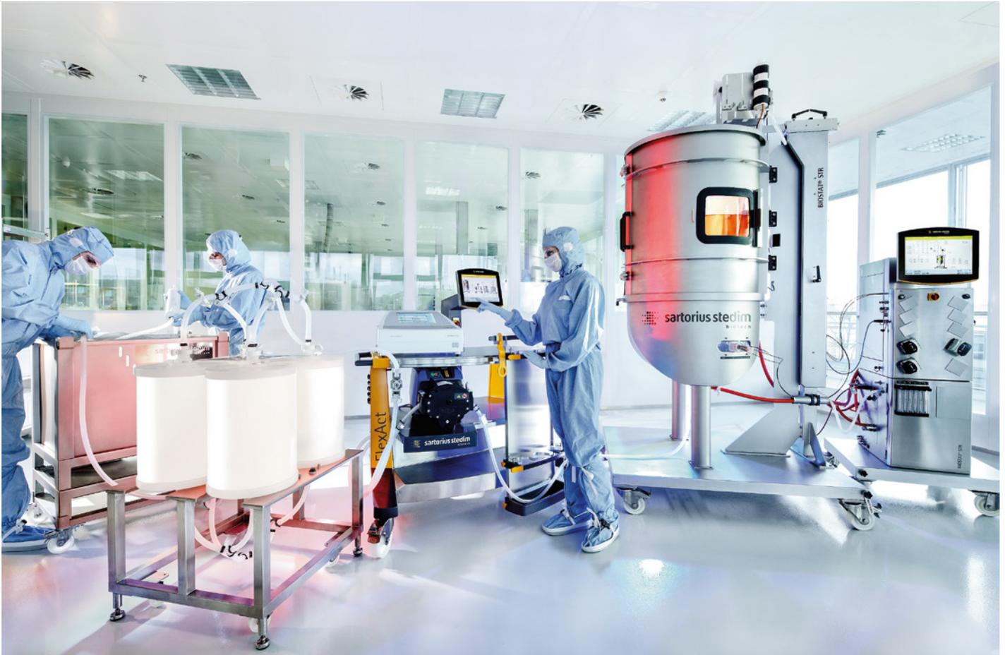
Damit die Zellen bei der Herstellung von biopharmazeutischen Wirkstoffen wachsen können, werden sie in einem Bioreaktor kultiviert.
