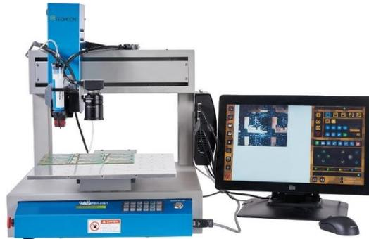
Le robot de dosage intelligent de la série TSR2000 est spécialement conçu pour les applications précises de distribution de fluides, et est compatible avec tous les types de valves et de commandes. Ce logiciel PC intelligent convivial permet de programmer et d'utiliser facilement le robot.
