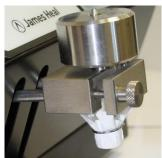
O dedo de fricção pode ser retirado, rodando no sentido inverso ao dos ponteiros do relógio o parafuso até que se liberte a pressão. Substituir o dedo de ficção. Aplicar pressão para montar o dedo, apertando o parafuso no sentido dos ponteiros do relógio.
