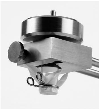
Der Reibfinger kann durch das Drehen der „Klemm-Schraube“ gegen den Uhrzeigersinn entfernt werden, während der Klemmdruck gelöst ist. Ersetzen Sie den Reibfinger. Legen Sie den Klemmdruck wieder an, um den Finger zu sichern, indem Sie die Klemm-Schraube im Uhrzeigersinn drehen.
