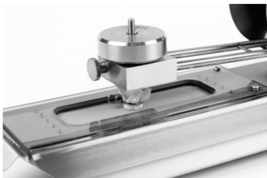
Bedecken Sie den Finger mit dem ungefärbte Reibgewebe und sichern seine Position mit Hilfe des dafür vorgesehenen Federclipses. Senken Sie den Kopfaufbau auf die Reibfläche und beginnen Sie mit der geradlinigen Bewegung durch Drehen des Griffs im Uhrzeigersinn wie durch den Pfeil
