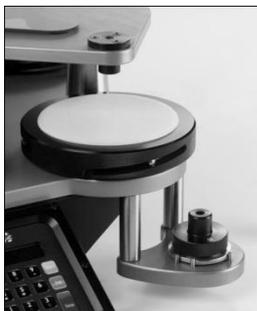
Coloque el cuerpo del Porta probetas en la Tuerca del mismo y enroscar con cuidado en sentido a las agujas del reloj hasta que quede apretado.
