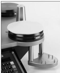
Coloque un trozo de Tejido Abrasivo SM25 de 140mm de diámetro, cara arriba y centrado encima del Fieltro.
