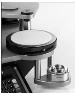
Coloque una probeta de 38mm de diámetro, cara abajo, centrado dentro del Soporte de la probeta.
