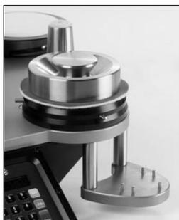
Con precaución, coloque el útil de preparación centrado encima de la muestra, con cuidado de no mover ni el Tejido ni el Fieltro.
