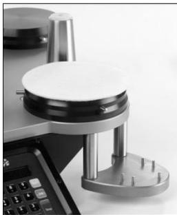
Coloque un Fielto de 140mm de diámetro centrado en la tabla de abrasión.
