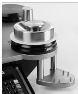
Con precaución, coloque el útil de preparación centrado encima del Tejido Abrasivo SM25, con cuidado de no mover ni el Tejido ni el Fielto.
