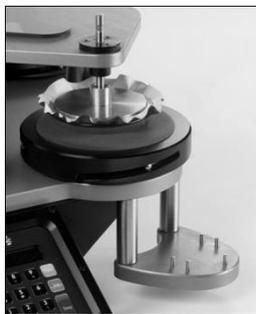
Normalmente un ensayo de Pilling requiere 3 probetas.
