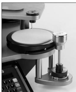
Añadir el peso de carga correspondiente ya sea 9 o 12 kPa y apretar el tornillo con la herramienta proporcionada.
