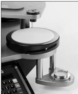
Coloque la espuma de poliuretano de 38mm centralmente en la tuerca del porta muestras sobre la muestra de tejido a ensayar.
