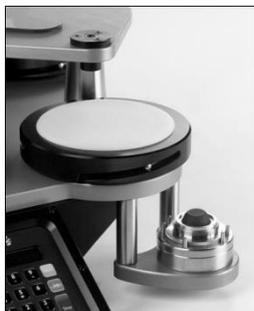
Coloque la bola de presión de caucho dentro hasta que haga contacto con la probeta.
