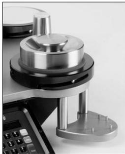
Coloque el Anillo de Sujeción Rápida sobre las (3) clavijas de bloqueo y girar en dirección a las agujas del reloj haciendo un poco de fuerza hacia abajo.
