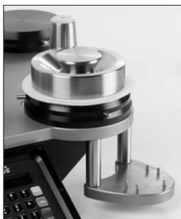
Con precaución, coloque el útil de preparación centrado encima del Tejido Abrasivo SM25, con cuidado de no mover ni el Tejido ni el Fieltro.
