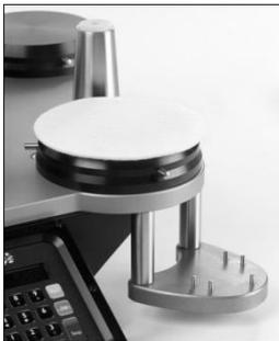
Coloque el fieltro de 140mm de diámetro centrado en la tabla de abrasión.
