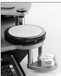
Coloque el Soporte de la probeta en el Útil de Bloqueo.
