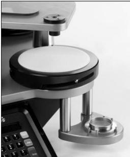
Coloque la muestra de 38mm de diámetro, cara abajo, y centrado sobre la Tuerca del Porta Probetas.
