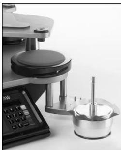
Presione suavemente el soporte de muestras contra el útil (use los pulgares) mientras que al mismo tiempo, enrolle con la goma de retención hasta que se agarre la muestra en el porta probetas de pilling.
