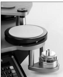
Coloque el Cuerpo del Soporte en el Soporte de la probeta y con cuidado acoplar con la rosca.
