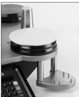
Coloque un trozo de Tejido Abrasivo SM25 de 140mm de diámetro, cara arriba y centrado encima del Fielto.
