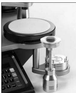
Compruebe que la muestra está bien sujeta. Nótese como la probeta sobresale del Soporte del porta muestras.
