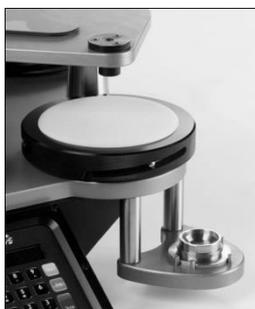
Coloque cuidadosamente el inserto del porta muestras en la tuerca de sujeción de probetas sobre la espuma de poliuretano.
