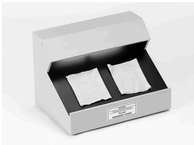
Szafka/przeglądarka oceny pillingu (PAV) wg. normy EN ISO 12945-1 and -2.
