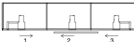
L'anta centrale ha la staffa superiore senza supporto laterale e in fase di apertura/chiusura subisce un'oscillazione maggiore rispetto alle due ante laterali.
