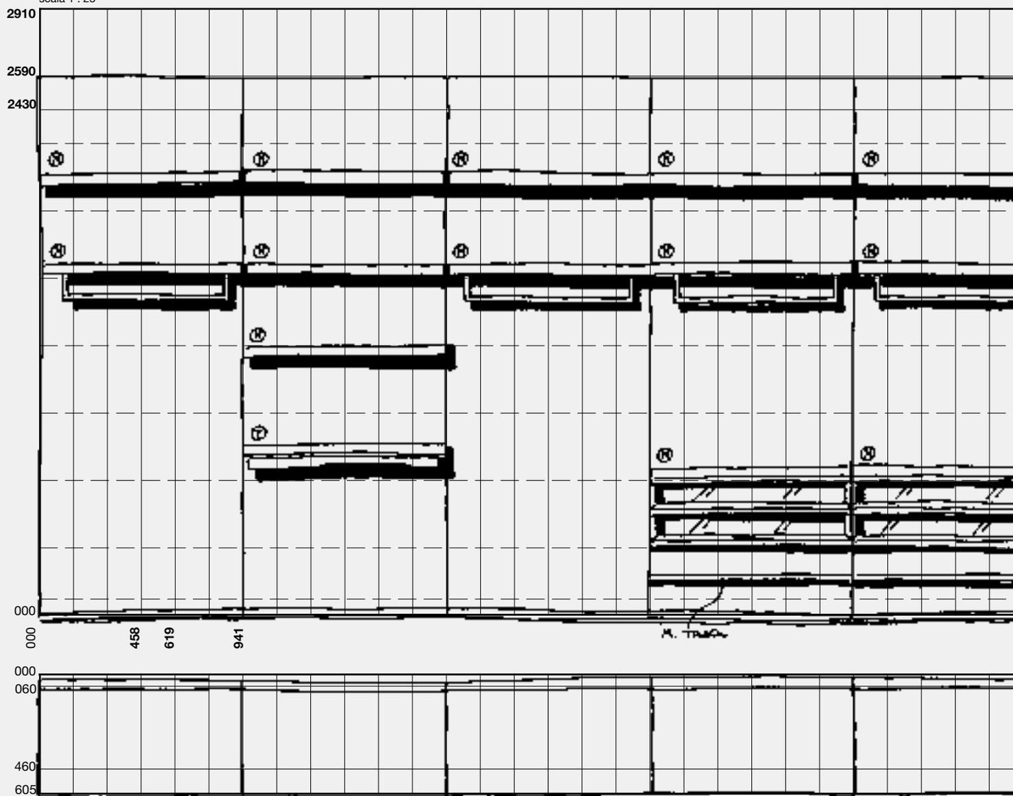
Per ottenere la dimensione totale, alla somma della larghezza degli schienali, aggiungere 32 mm. per il profilo laterale iniziale, 4 mm. per ogni cremagliera e 32 mm. per il profilo laterale t
