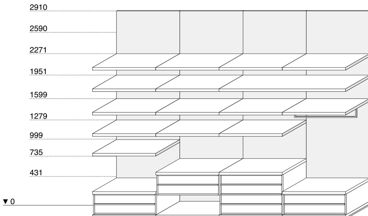
NOTE: Le altezze indicate per il posizionamento delle attrezzature sono indicative. Il sistema di fissaggio con staffe e cremagliera permette il libero posizionamento in altezza (passo 32 mm). L'ultimo ripiano in altezza, può essere posizionato a 63 mm. dal filo superiore dello schienale.
