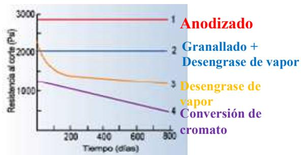
Resistencia de la unión de aluminio/resina epoxi - Inmersión H<sub>2</sub>O
