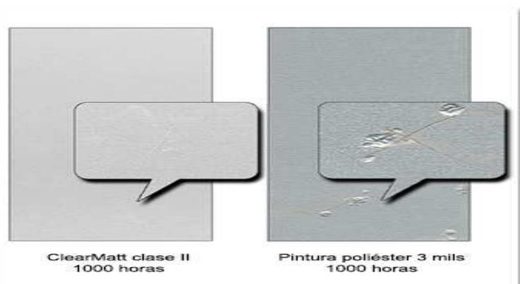
ASTM B 117 Resistencia a la exposición a sal pulverizada
