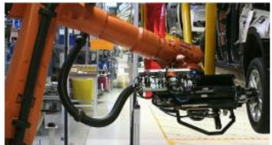
Ilustración 1: Sistema de ensamblaje montando ruedas en vehículos en continuo movimiento
