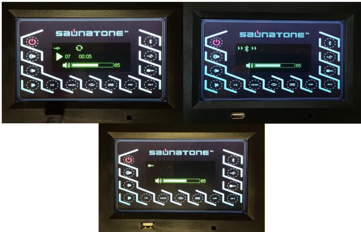
Через несколько секунд экран аудио автоматически вернется на экран управления сауной. Теперь в середине экрана отображается значок, указывающий на функцию аудио, которая все еще работает на экране аудио.
