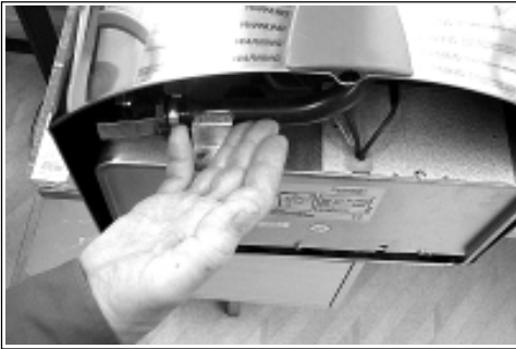
Kuva alapuolelta: Irrota vesijohto kannattimelta niin, että se roikkuu suoraan alaspäin.
