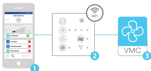
L'interfaccia utente user-friendly rende l'utilizzo della Smart App Helty facile ed intuitivo e fornisce informazioni riguardo alla **qualità dell'aria interna**, indicando i valori rilevati di umidità, temperatura, concentrazione di VOC e di CO<sub>2</sub>\*
