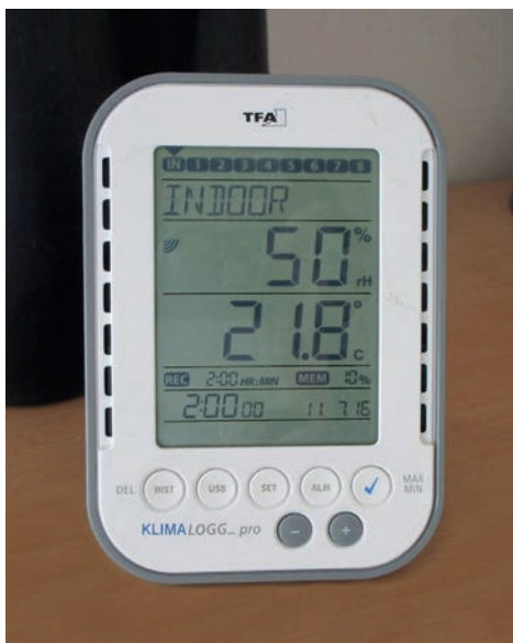
Fig. 1.8 Il valore ottimale di Umidità Relativa dell'aria interna nelle abitazioni è del 50%, se si riesce a mantenerla su questo livello, la formazione di muffe diventa molto improbabile e quasi impossibile.
