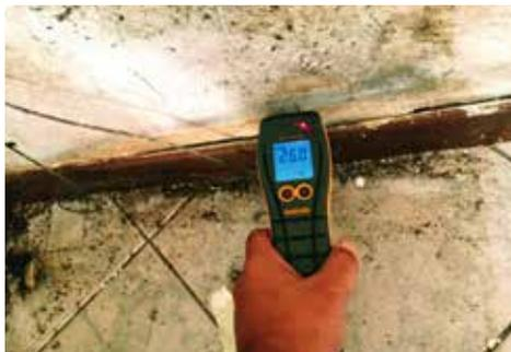
Fig. 2.8 Le misurazioni strumentali sono molto utili per aiutare a capire le cause che hanno favorito la formazione di muffe. Nella foto un igrometro a contatto di tipo resistivo con il quale si può rilevare il valore di umidità contenuta nell'intonaco.
