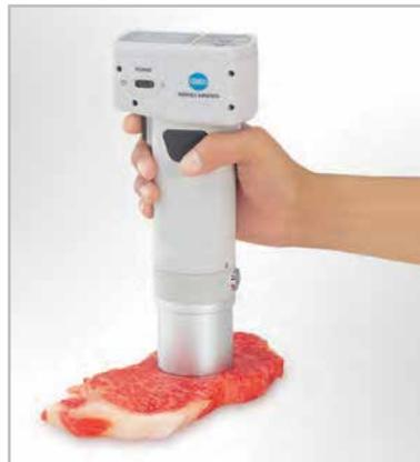
El CR-400 tiene un tamaño de apertura de medición de  $\varnothing$  8mm ideal para muestras homogéneas y áreas pequeñas.
