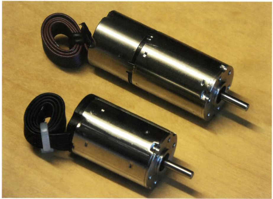
Samme motor, med og uten integrert styreelektronikk.
