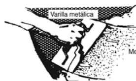
Figura 5 Aplique la mezcla con un fratacho.
