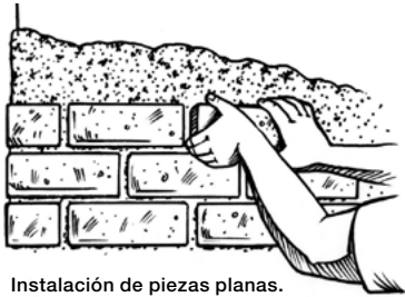
Instalación de piezas planas.
