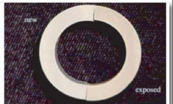
كلوريد البولي فينيل الكلور CPVC : اختبار على أرض الواقع لمدة 24 شهر
