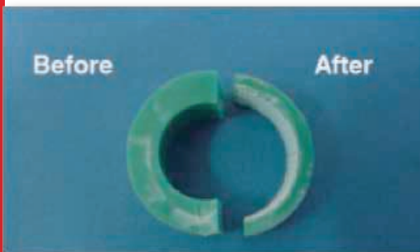
تآكل البولي بروبيلين بعد عشرة أشهر (معدل الكلور: 5 أجزاء في المليون)
