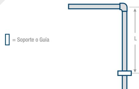
No colocar contra una estructura fija (columna, viga o pared)
