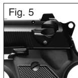
Mod. G Sólo palanca de desarme - Volver a la posición de listo para disparar
