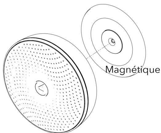
Fixer le support de montage au mur ou au plafond. Assurez-vous que vous utilisez des vis adaptées à votre type de mur. Les vis fournies sont prévues pour du bois ou du gyproc. Ne pas installer à proximité de bouches d'air ou de fenêtres. Distance minimale 1 mètre / 3 pieds.
