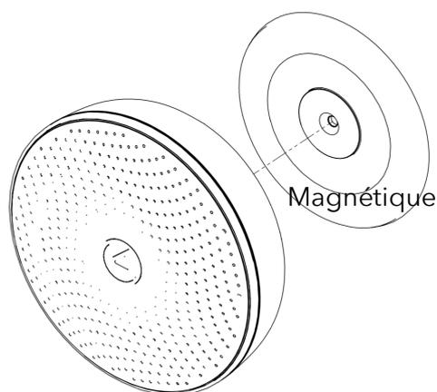
Fixer le support de montage au mur ou au plafond. Assurez-vous que vous utilisez des vis adaptées à votre type de mur. Les vis fournies sont prévues pour du bois ou du gyproc. Ne pas installer à proximité de bouches d'air ou de fenêtres. Distance minimale 1 mètre / 3 pieds.
