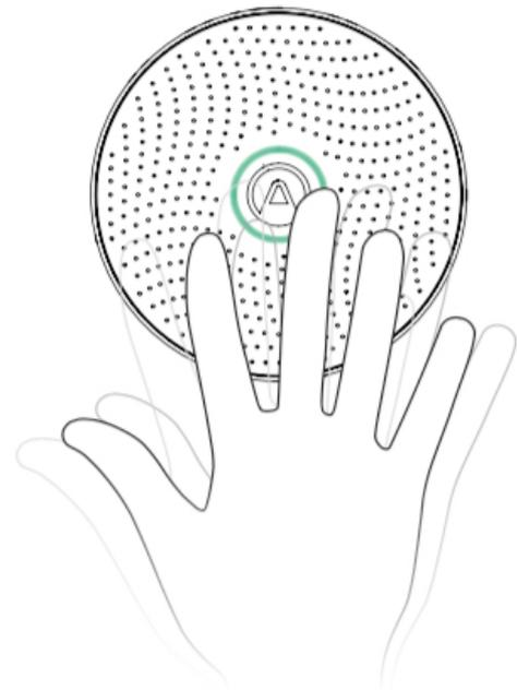
Pase la mano por delante de su dispositivo para obtener una indicación visual de sus niveles diarios de radón. Deje su Wave en funcionamiento ininterrumpido durante 1 semana para obtener una lectura de calidad media para radón.
