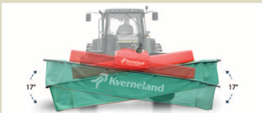
Paras mahdollinen liikevara saadaan kun niittoyksikköä voidaan hallita erillään etunostolaitteesta.
