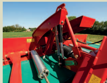
Integroitu kevennysrakenne mahdollistaa hyvän esteitten väistämisen.
