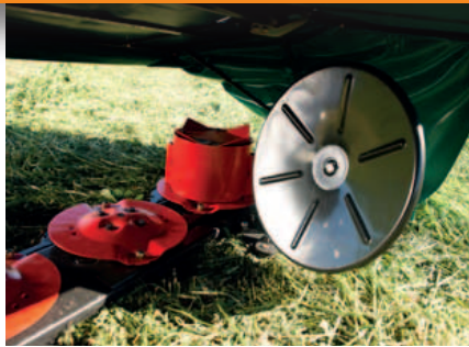
Lisävarusteena saatava karhotusrulla erottaa niittämättömän luo'on kasvustosta.
