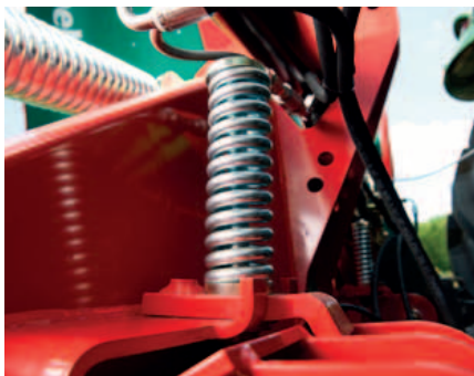
Laukaisulaite automaattisella palautuksella.
