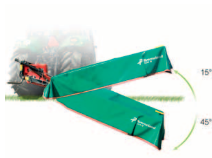
Teräpalkin liikevara on 15° ylöspäin ja 45° alaspäin.
