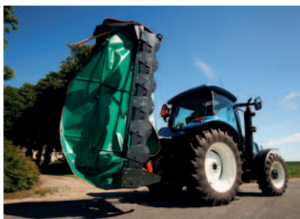
2300-sarjan niittokoneet taitetaan kuljetusasentoon kääntämällä ne ylös.
