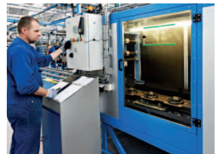
Kaikki teräspalkit testikäytetään ja tarkistetaan melu ja lämpötila.
