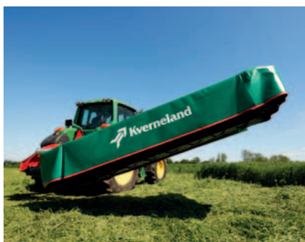
Nosto päisteissä hydraulisylinterillä - riittävästi maavaraa.
