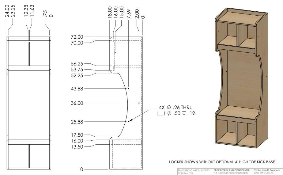
EACH LOCKER WILL INCLUDE HARDWARE FOR SIDE TO SIDE CONNECTION TO ADJACENT LOCKERS, SILVER COLOR
