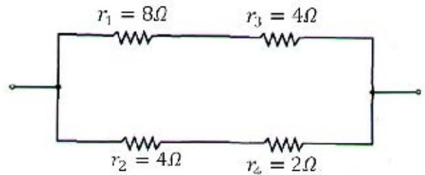
Assinale a alternativa que equivale à potência dissipada pelo resistor 3 quando uma ddp de 12 V é aplicada sobre os terminais do circuito apresentado.
