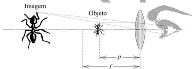
Nessa figura, é mostrada uma lupa simples consistindo de uma lente convexa. O objeto a ser ampliado é posicionado de forma que a respectiva distância  $p$  da lente seja menor que a distância focal  $f$ . A ampliação linear  $M$  é a relação entre o tamanho da imagem e o tamanho do objeto e é dada por  $M = f/(f - p)$ . Caso se deseje uma ampliação linear mínima igual a 3, ou seja, uma imagem que seja pelo menos três vezes maior que o objeto, então deve-se ter
