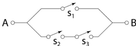
Um circuito elétrico tem três chaves de ligamento e desligamento  $S_1$ ,  $S_2$  e  $S_3$ , como representado na figura. As chaves operam independentemente uma da outra, e a corrente fluirá de A para B se  $S_1$  estiver fechada ou se  $S_2$  e  $S_3$  estiverem ambas fechadas. Se  $p(S_k) = \frac{1}{2}$  é a probabilidade de a chave  $S_k$  estar ligada para  $k = 1, 2, 3$ , então a probabilidade de uma corrente elétrica fluir do ponto A para o ponto B é igual a
