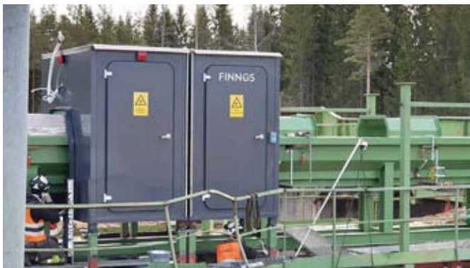
▲ Haka-Woodille toimitettavassa Finnos Lite 3D Optimizer -tukkimittarissa on kuvanmukainen lasikuitusuoja. Kuvituskuva.
