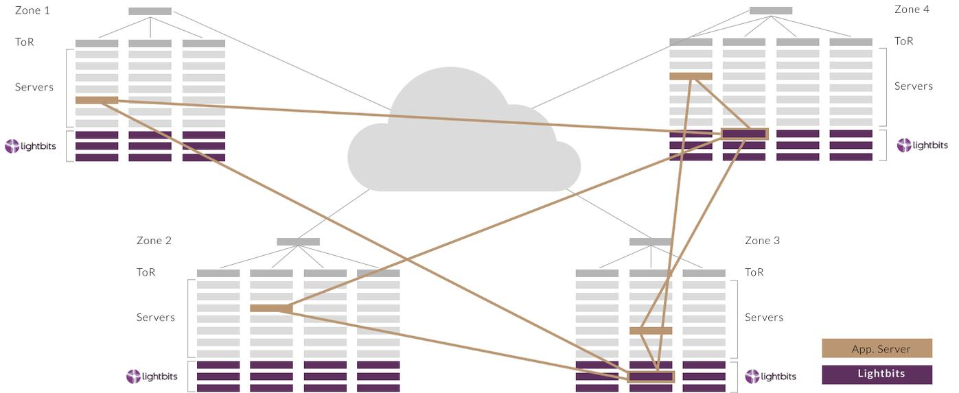
图 3: NVMe / TCP 将存储节点连接到整个数据中心的应用程序服务器
