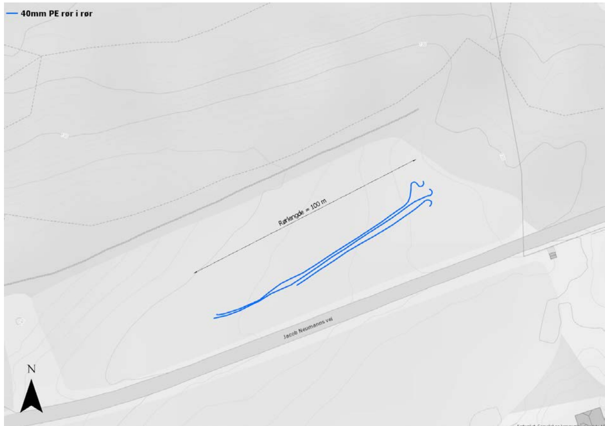
Bilde 9 – Innmålt trase for 40 mm rør i rør.
