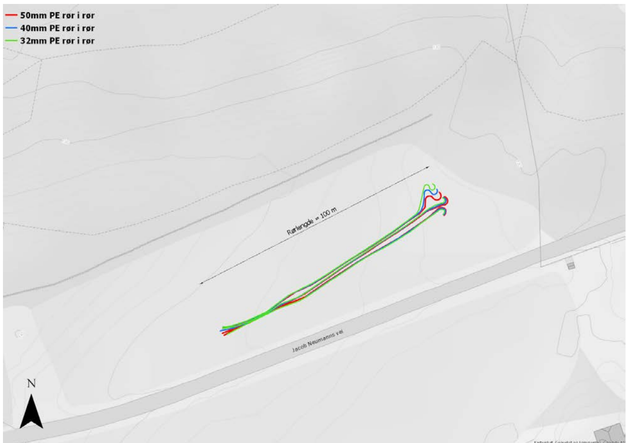
Bilde 6 – innmåling av vannledning viser avvinkling. Test gjennomført på riggplass.
