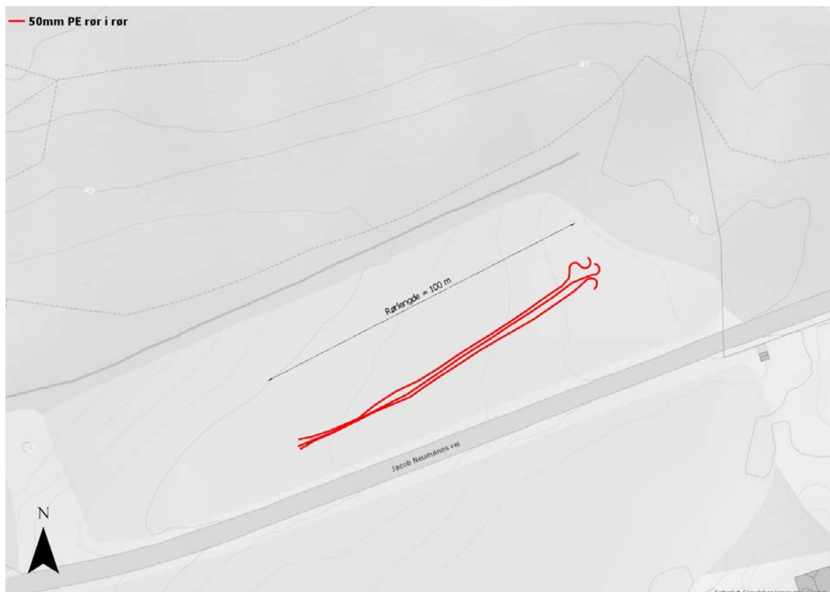
Bilde 10 - Innmålt trase for 50 mm rør i rør.
