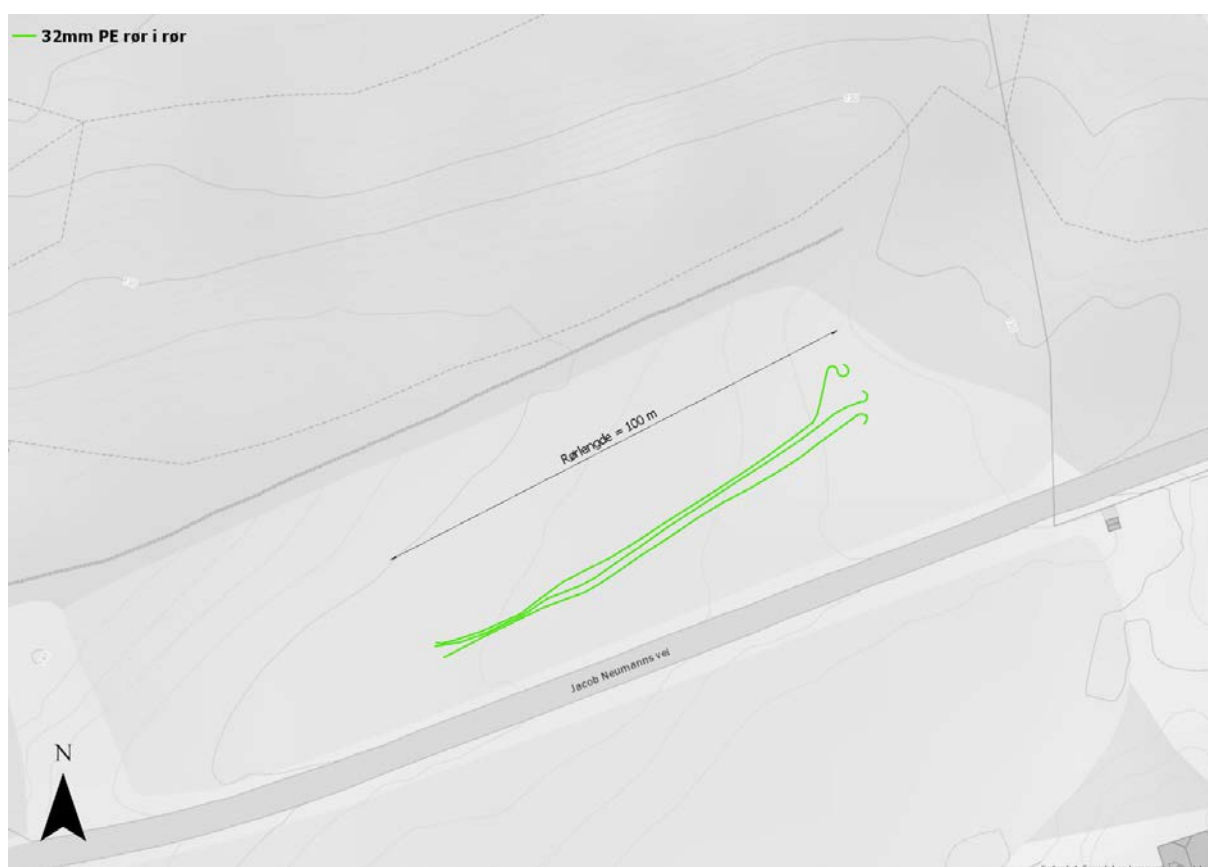
Bilde 8 – Innmålt trase for 32 mm rør i rør.
